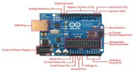
Fig.9: Arduino uno (Microcontroller)
