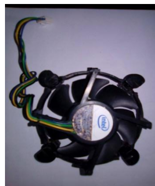
Fig 3: CPU cooling fan
